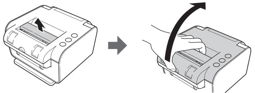
**3** 上カバーの内側にインクリボンカートリッジを取り付けます。
